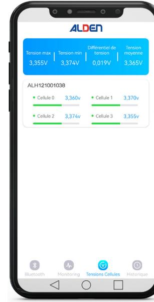
Système de gestion de batterie intégré Bluetooth 4.0 via l'application BMS ALDEN
